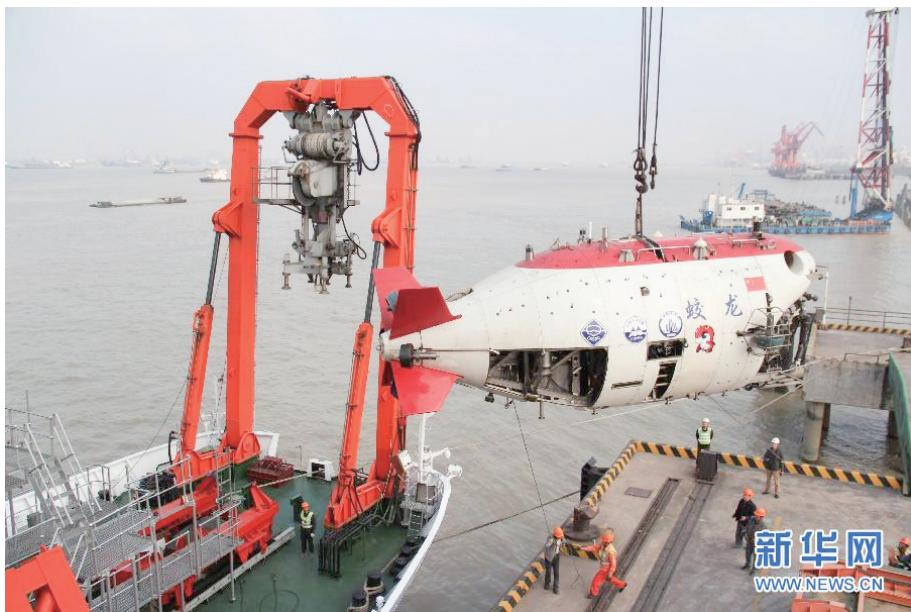
▲江阴苏南国际码头，“蛟龙号”载人深潜器被安装在母船“向阳红 09”船的支架上
